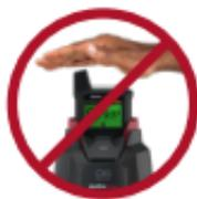
**ADVERTENCIA:** Cuando el dispositivo G6 se bloquee en la base, presione sobre las luces indicadoras superiores. No presione la antena, ya que de lo contrario los contactos de datos y alimentación podrían desconectarse.
