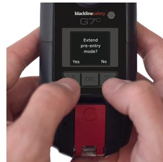
Si no confirma que desea ampliar el tiempo de espera del modo en el plazo de 30 segundos, el G7 volverá al modo normal y si el registro (check-in) está activado, le pedirá que se registre.
