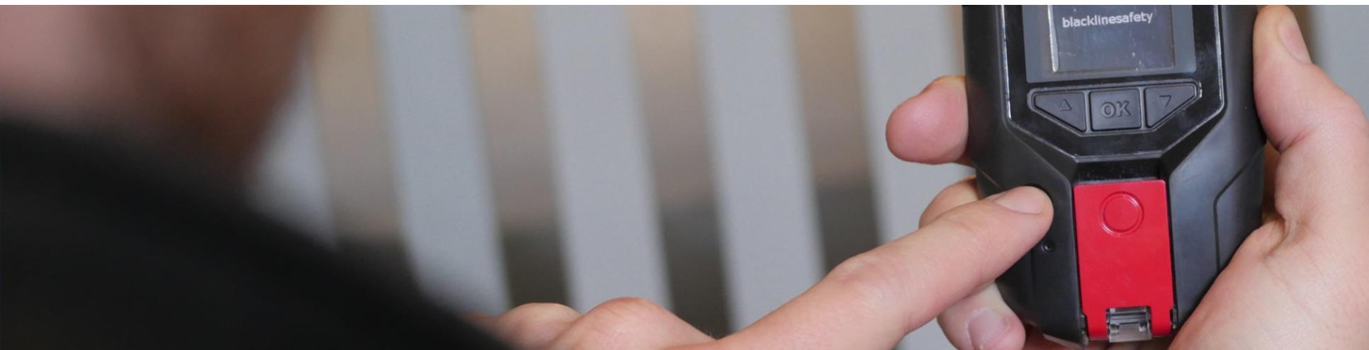
Pulse el botón de encendido una vez para encender el dispositivo.
