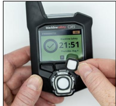
4. Coloque o novo filtro sobre o sensor, assegurando-se de que o retentor do filtro fica virado para fora do dispositivo e corretamente alinhado dentro do encaixe do sensor de gás.
