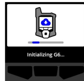
**HINWEIS:** Stellen Sie sicher, dass dem Gerät zur Durchführung der erforderlichen Aktualisierungen ausreichend Zeit zur Verfügung steht. Die Initialisierung kann bis zu 30 Minuten dauern, wenn ein O<sub>2</sub>-Gerät eine längere Zeit zur Stabilisierung seines Sensors benötigt.
