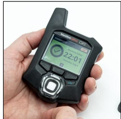
5. Bringen Sie die Gassensorkappe wieder am G6 an, indem Sie die Kappenhalterungen schräg zur Oberseite des G6 einsetzen und die Unterseite der Kappe bis zum Einrasten drücken.
