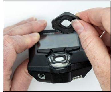
3. Entfernen und entsorgen Sie den alten Filter und achten Sie darauf, dass er nicht mit der Oberfläche des Gassensors in Berührung kommt.
