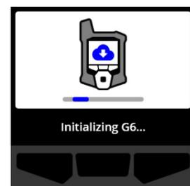
**OBSERVAÇÃO:** Aguarde o tempo necessário para que o dispositivo conclua as atualizações necessárias. A inicialização pode durar 30 minutos se um dispositivo de detecção de O<sub>2</sub> necessitar de tempo prolongado para estabilizar o seu sensor.
