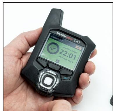
5. Recoloque a tampa do sensor de gás no G6, inserindo os suportes da tampa formando um ângulo com a parte superior do G6 e pressionando a parte inferior da tampa até que ela se encaixe no lugar.
