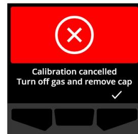
**IMPORTANTE:** Se o G6 estiver apresentando um erro de sensor, não será possível realizar uma calibração até que o erro do sensor seja solucionado.
