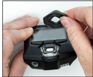
3. Remova e descarte o filtro antigo, evitando o contato com a superfície do sensor de gás.
