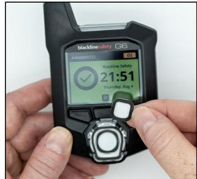
4. Coloque o novo filtro sobre o sensor, certificando-se de que a junta do filtro esteja voltada para o dispositivo e corretamente alinhada dentro do encaixe do sensor de gás.
