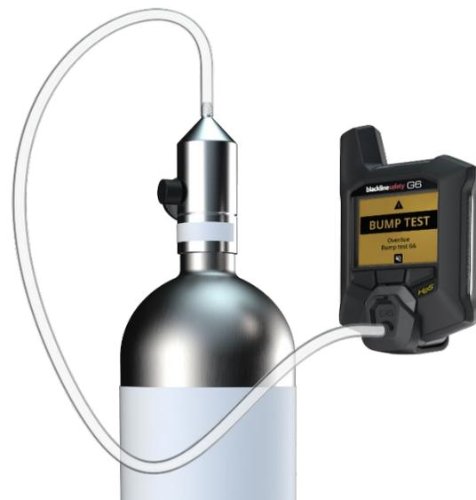
O G6 comunica automaticamente os dados do teste de resposta à Blackline Live na próxima sincronização programada do dispositivo e lembrará o usuário quando um teste de resposta estiver atrasado.
