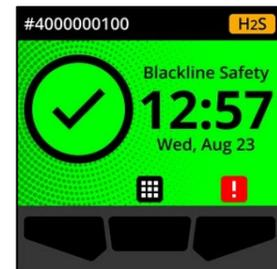
Se o estado do G6 não estiver conforme (por exemplo, uma calibração ou teste de resposta está atrasado), ou se houver anormalidades relacionadas ao gás, avisos de bateria fraca ou erros no dispositivo, a tela inicial do G6 exibirá o estado da notificação.
