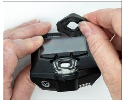
3. Entfernen und entsorgen Sie den alten Filter und achten Sie dabei darauf, die Oberfläche des Gassensors möglichst nicht zu berühren.
