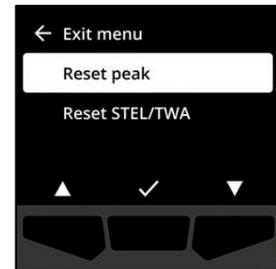
5. Bei Geräten mit H<sub>2</sub>S-, CO- oder SO<sub>2</sub>-Messung: Um den Spitzengasmesswert auf Null zurückzusetzen, wählen Sie
