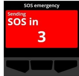
Sobald die Countdownsequenz abgeschlossen ist, setzt das Gerät manuell einen Notruf an den/die Notfallkontakt(e) ab, die im Blackline-Live-Antwortprotokoll konfiguriert sind und fordert sofortige Hilfe an Ihrem Standort an.
