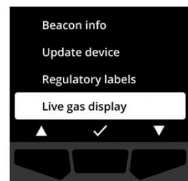
2. Scrollen Sie anhand der Navigationstasten durch die Liste und wählen Sie dann, ob Sie die Live-Gasanzeige ein- oder ausschalten möchten, indem Sie die mittlere Taste (☑) drücken.
