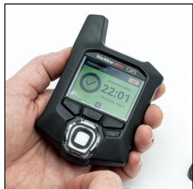
5. Bringen Sie die Gassensorkappe wieder am G6 an, indem Sie die Kappenhalterungen schräg zur Oberseite des G6 einsetzen und die Unterseite der Kappe drücken, bis sie einrastet.
