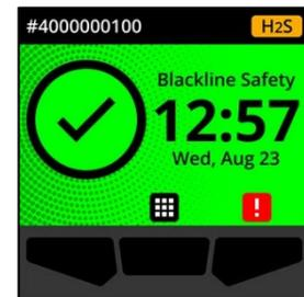
Ist das G6 nicht konform (z. B. ein Funktionstest oder eine Kalibrierung ist überfällig) oder liegen gasbezogene Auffälligkeiten, Akkuladestandswarnungen oder aktive Gerätefehler vor, wird der Benachrichtigungsstatus auf dem Hauptbildschirm des G6 angezeigt.
