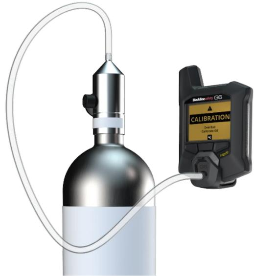
Manuelle Kalibrierung des G6 unter Verwendung einer Kalibrierkappe und eines Kalibrierschlauchs:
