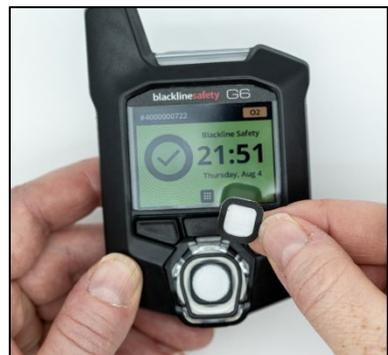
4. Setzen Sie den neuen Filter über den Sensor und achten Sie dabei darauf, dass die Filterdichtung in Richtung Gerät weist und ordnungsgemäß in der Gassensor-Buchse ausgerichtet ist.
