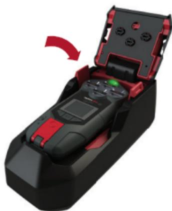
2. Mantenendo le clip di ricarica connesse, appoggiare il dispositivo G7 nel dock e spingere verso il basso fino a quando non scatta in posizione.
